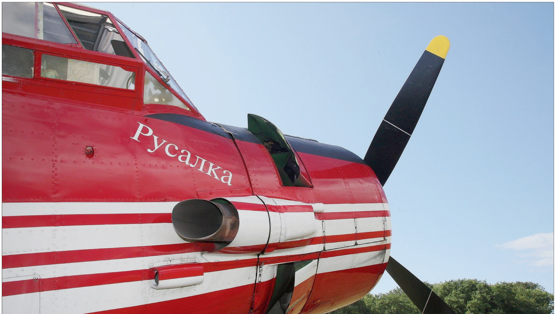
Cet Antonov-2 (AN-2) baptisé Rusalka est le magnifique représentant d'un modèle robuste et polyvalent conçu en 1947 qui présente la particularité d'être le plus gros biplan monomoteur du monde.
